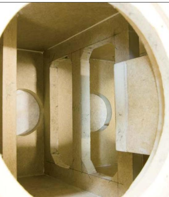
Die Versteifung, auf Englisch „Brace“, sitzt bewusst asymmetrisch, um die Resonanzen von Kammern und Wänden maximal zu spreizen
