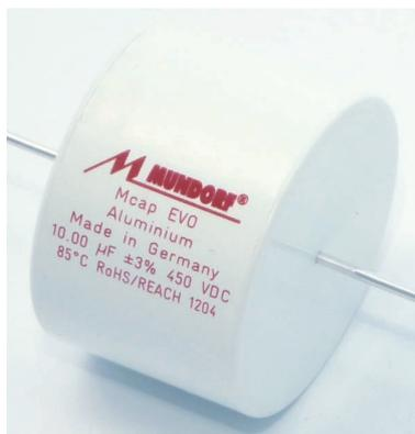
Der **MCap® EVO** wurde 2012 als Nachfolger des RXF entwickelt, um höchsten Musikgenuss auch bei begrenzten Platz- und Budgetverhältnissen zu ermöglichen. Der verwendete PP-Kondensatorfilm wird erst mit einer maximal dicken Aluminiumschicht bedampft, dann in der innovativen EVOLUTION-Technologie präzise gewickelt und anschließend in speziellen Gehäusen von Hand vergossen.
